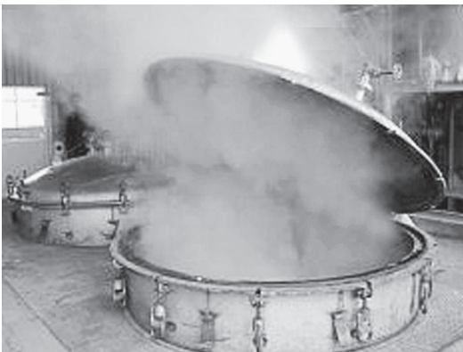
オホーツクはまなす農協滝上支所のハッカ蒸留窯。深さ2.5メートル、直径2.1メートルの窯が2つある。1窯に800キロ入り、1回で10から20キロの精製油がとれるという。ふたを開けるとさわやかな香りに包まれる
